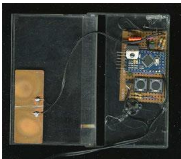
Elektronische Morsetaste: Links die beiden kapazitiven Flächen, rechts der Arduino in blau und Taster zur Geschwindigkeitskontrolle
